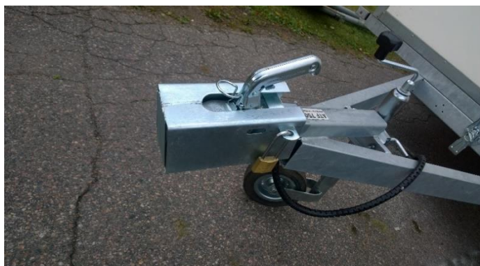
Bild 1: Dragstångslåset fastkopplat på släpet.
