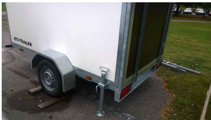
Bild 4: Släpvagnens bakben nedställda
