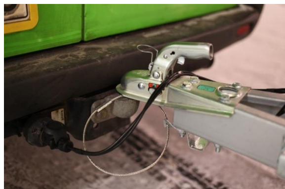
Bild 2: Koppling av släpet till bilens dragkrok
