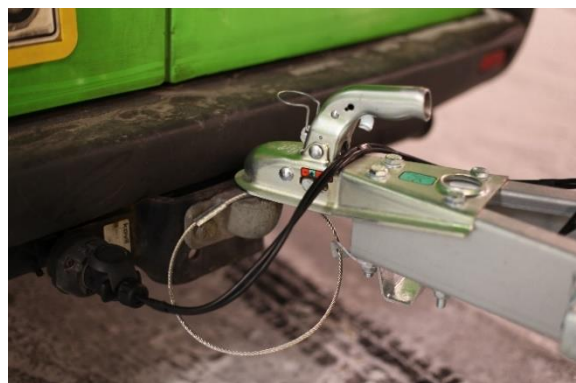
Kuva 2. Trailerin kiinnitys vetokoukkuun
