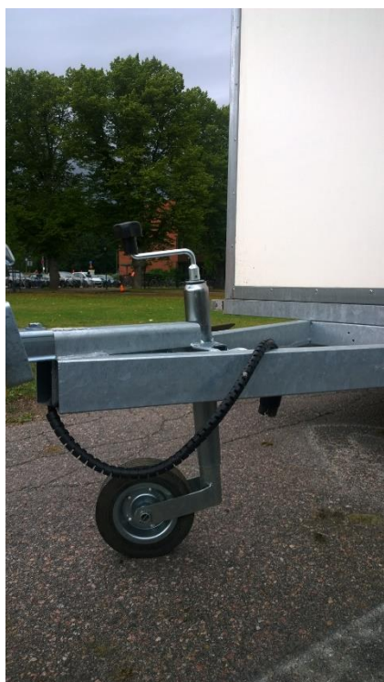
Kuva 3. Trailerin nokkapyörä ala-asennossa (traileri irti autosta)
