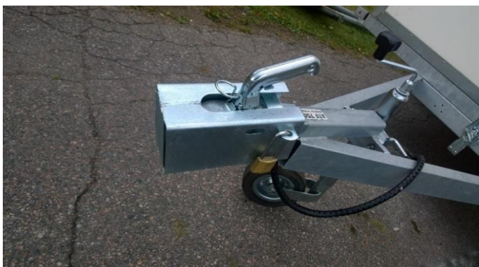
Kuva 1. Aisalukko kiinnitettyä traileriin
